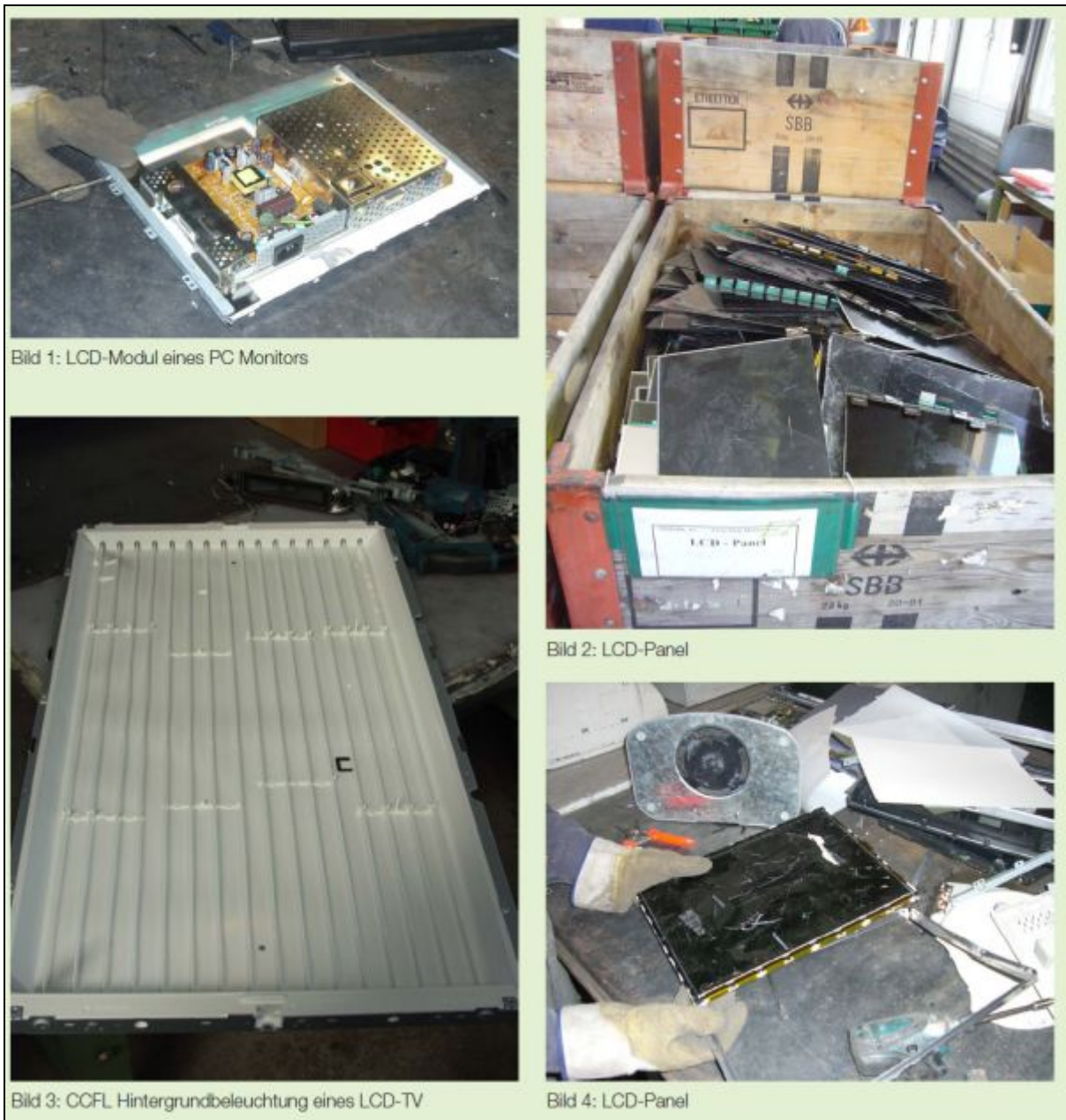
Abbildung 13 Bauteile von LCD-Bildschirmen (EMPA, SWICO Recycling 2011)
