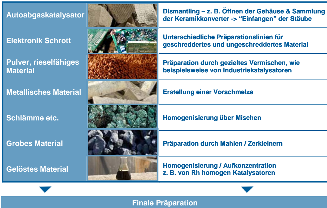
Abbildung 42 Zusammenstellung der wichtigsten Vorbehandlungs- bzw. Präparationsverfahren
