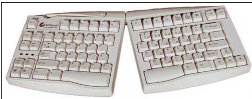
Abbildung 4 Geteilte Tastatur mit verstellbarem Neigungswinkel. (Quelle: www.ergo2work.de )
