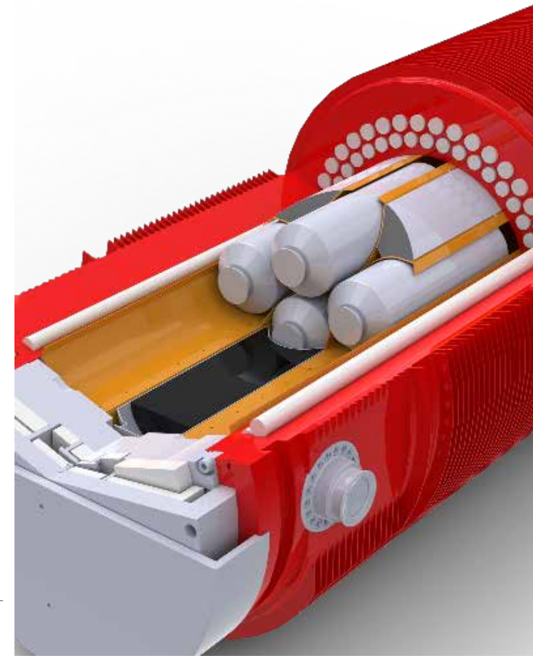
Quelle | Bild: Castorbehälter im Schnitt © GNS
