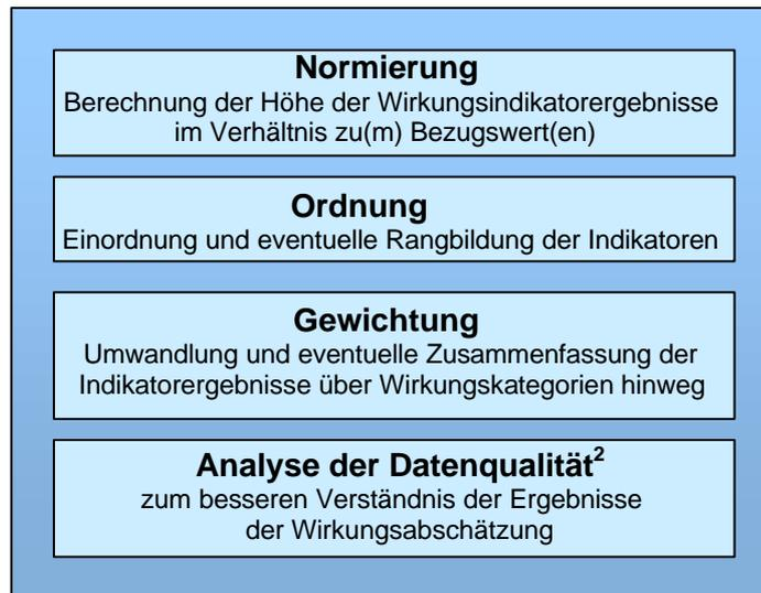
**Abbildung 4: Wahlweise Bestandteile der Wirkungsabschätzung (DIN 14042)**
