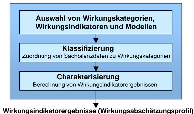
Abbildung 3: Verbindliche Bestandteile der Wirkungsabschätzung (DIN 14042)
