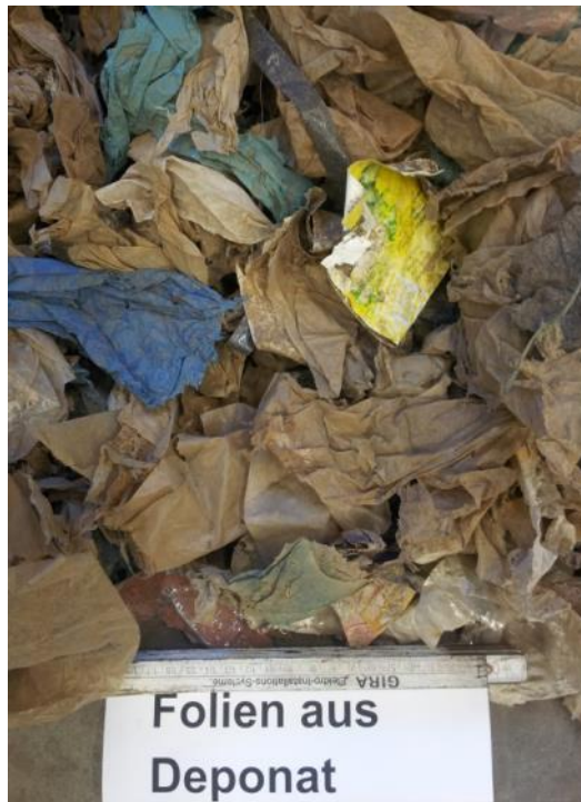
Abbildung 5-8: Abgetrennte Folien aus rückgebautem Deponiematerial
