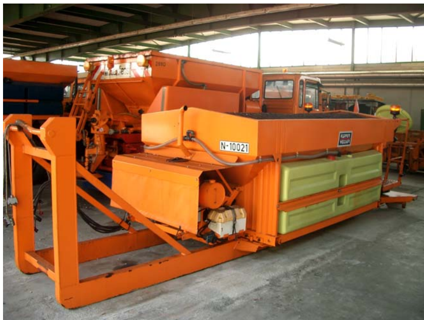
Abb. 4: Wechselstreueinrichtung für Feuchtsalz.
