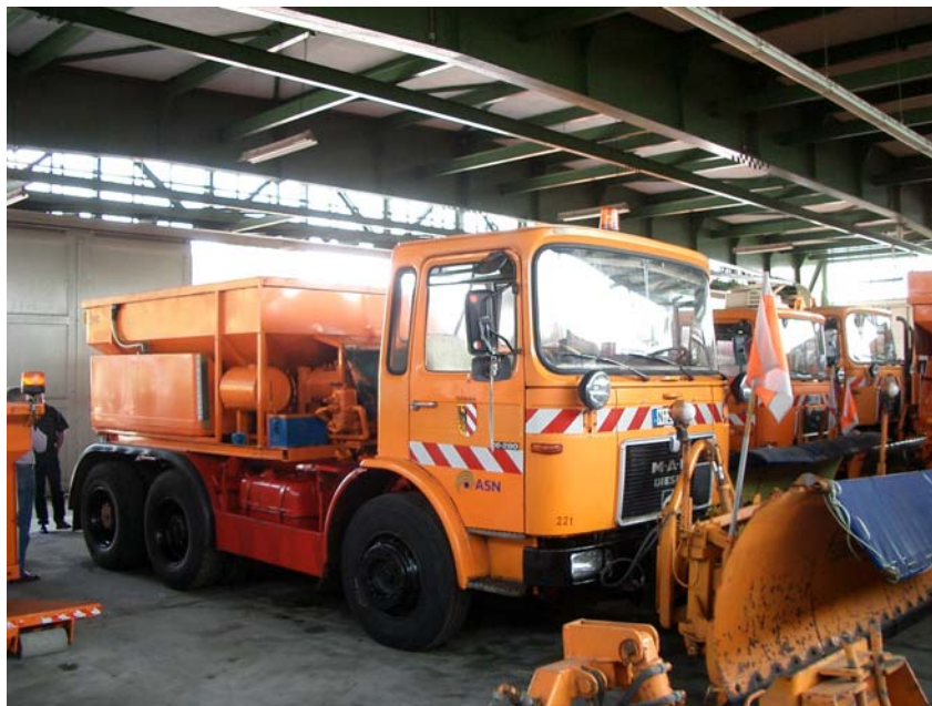
Abb. 3: Umgebautes Müllfahrzeug mit fest installierter Feuchtsalzstreueinrichtung und Pflug.
