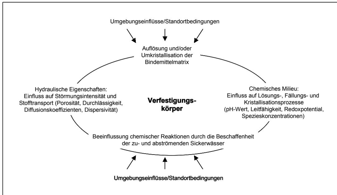
Abbildung 2.6 Wechselseitige Beeinflussung von Wirkmechanismen zur Prognose des Langzeitverhaltens
