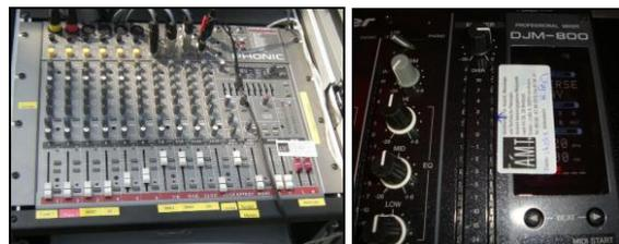
Abb. 5: Beispiele für Einpegelungen direkt am Mischpultplatz (Fotos: AMT)
