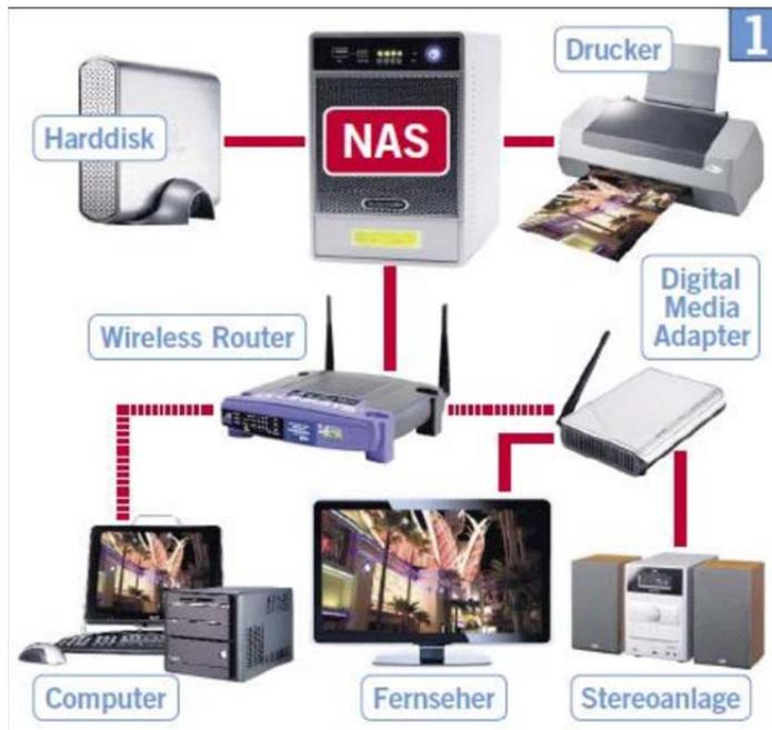
Abbildung 3 Beispielhafte Einbindung eines NAS ins Netzwerk (direkt aus Channelpartner 2012a)
