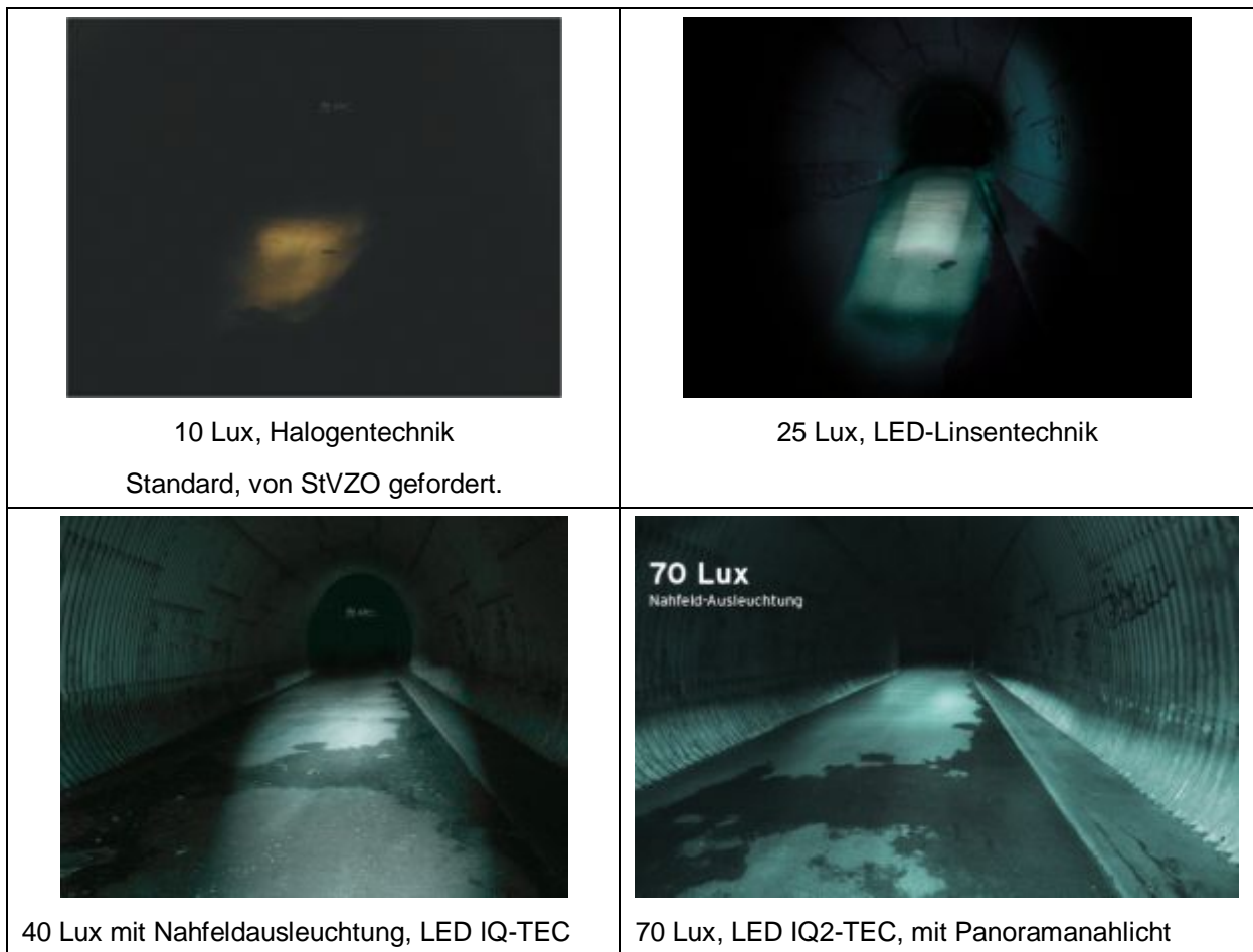
Abbildung 6 Vergleich der Ausleuchtung verschiedener Scheinwerfer (Busch & Müller KG 2012)
