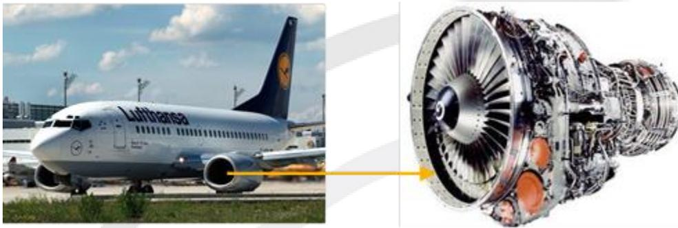
Abbildung 15: CFM 56-3 Triebwerk mit Acoustic Panels an der B737. Quellen: Lufthansa, CFM International (Triebwerkshersteller)
