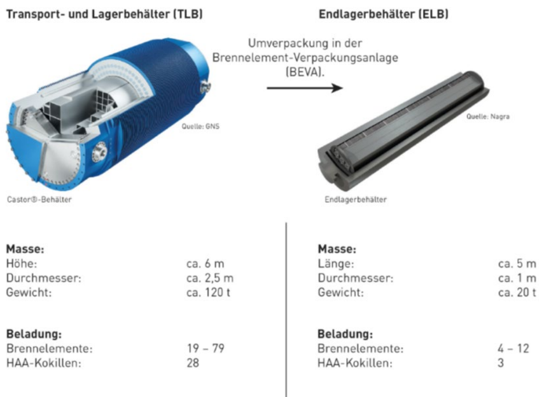
Abbildung 3: Beispiele für Transport- und Lagerbehälter (hier Castor-Behälter) und Endlagerbehälter (Konzept Nagra), (Nagra 2020a)
