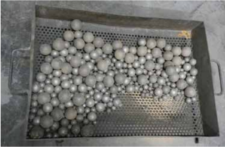
Abbildung 20 eingesetzte Mahlkörper – Kugeln verschiedener Durchmesser (Quelle ECG)
