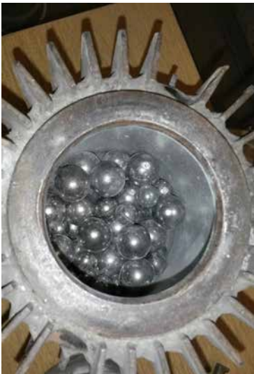
Abbildung 24 „Planet“ – Mahlraum mit Mahlkörperfüllung (Quelle ECG)
