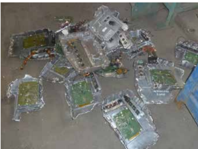
Abbildung 16 Gehäusebestandteile ohne vollständigen Aufschluss – Wiederaufgabe (Quelle ECG)
