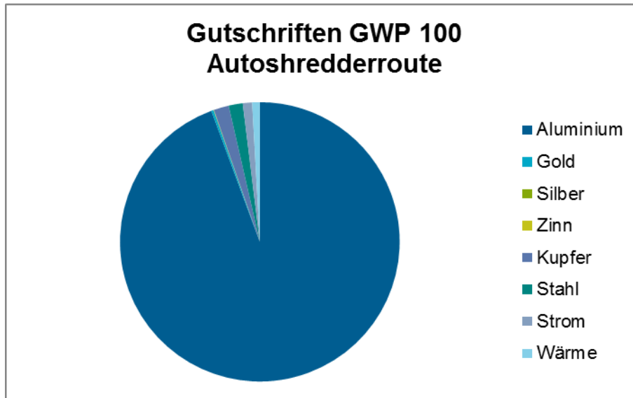
Abbildung 5-3: GWP: Gutschriftenanteile für die Autoshrredderroute
