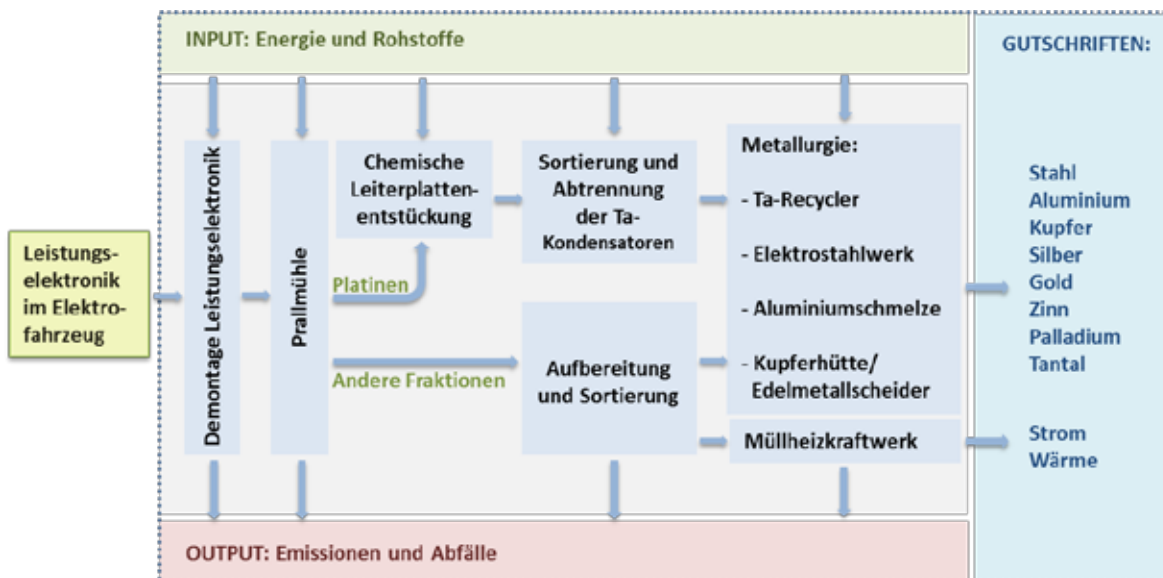
Abbildung 3-3: Systemgrenze der Elektrorecyclingroute mit chemischer Platinentstückung, FU: Recycling von 1000 kg EoL-Leistungselektronik
