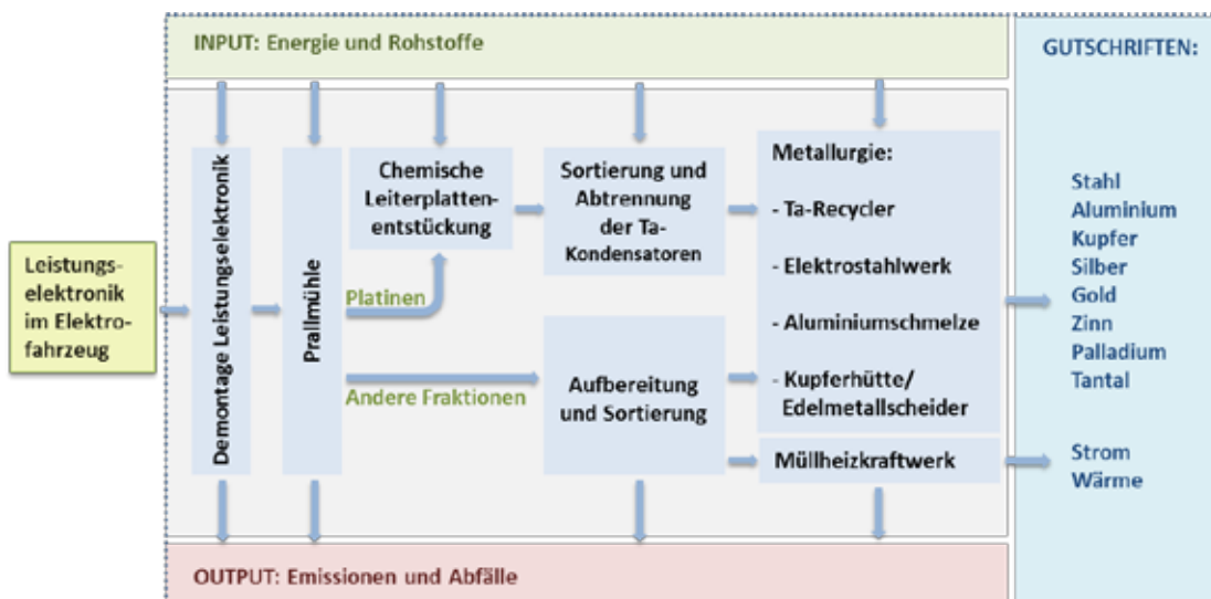
Abbildung 32 Systemgrenzen der Elektrorecyclingroute mit chemischer Platinenentstückung
