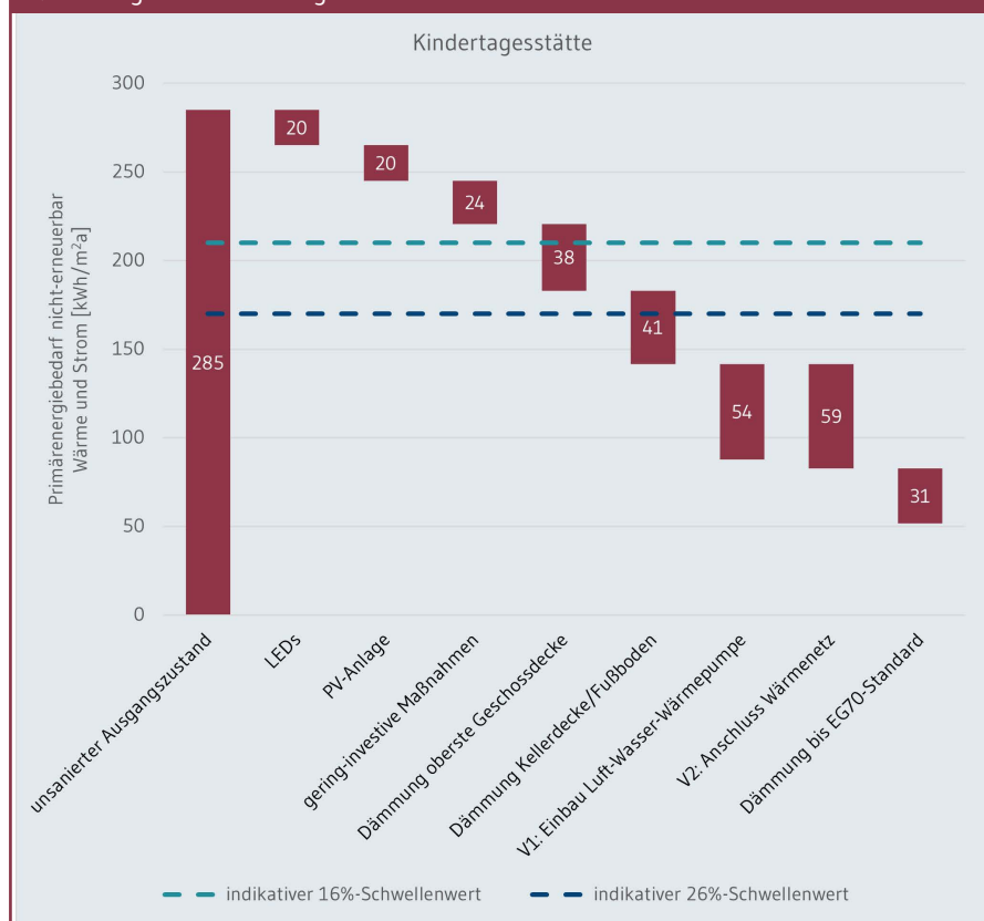
Abbildung 15: Energiebedarfsberechnung von technischen Maßnahmen zur Erreichung eines indikativen MEPS-Schwellenwertes für eine Kindertagesstätte Quelle: eigene Berechnung
