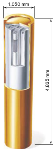
Abb. 3.3 Endlagerbehälter für ausgediente Brennelemente, Abmessungen in mm, Schweden
