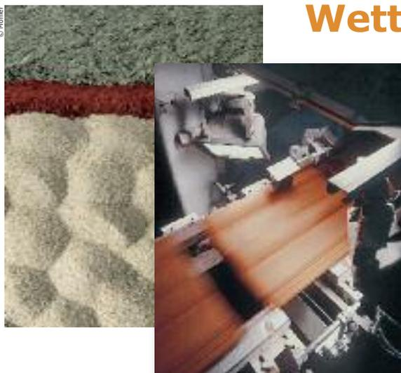
Dachsteine bestehen aus hochwertigem, gewaschenem Sand, zu Zement gebranntem Kalkstein, Eisenoxidpigmenten und Wasser.
