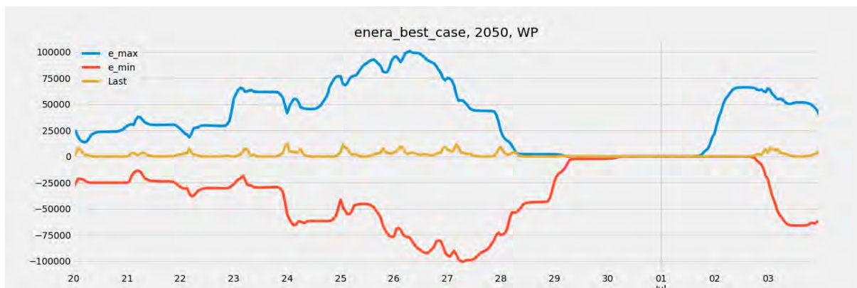
Abbildung 3.2-1: Zeitlicher Verlauf der Füllstands-Grenzen eines fiktiven Speicher-Äquivalents für die gesamtdeutsche Nachfrage für Wärme aus Wärmepumpen in zwei beispielhaften Wochen: obere Füllstands-Grenze (blau), untere Füllstands-Grenze (rot) und Nachfrage (orange) [MWh].
