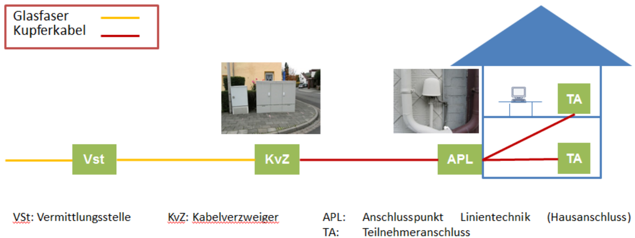
Abbildung 5: Bislang gängige Breitband-Versorgungsinfrastruktur nach Glasfaserausbau
