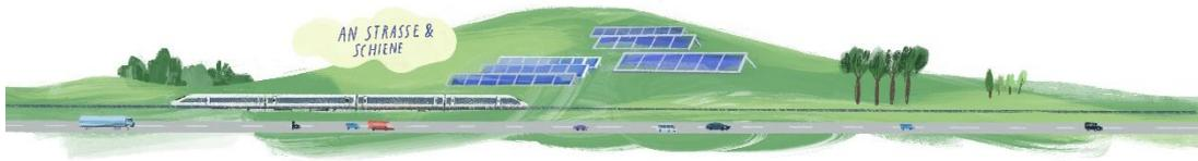
Neben Autobahnen und Schienenwegen mit mindestens zwei Hauptgleisen können innerhalb eines Abstandes von 500 m EEG-geförderte PV-FFA errichtet werden. Geregelt ist dieser Teil der PV-FFA Flächenkulisse in §37 Abs. 1 Nr. 2c EEG 2023. Die Vergütungsregelung gemäß §48 Abs. 1 Nr. 3 Buchstabe c) Doppelbuchstabe aa) erfasst auch eingleisige Schienenwege (Clearingstelle | EEG KWKG 2023).
