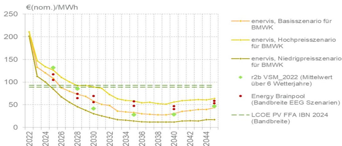
**Abbildung 8. Gegenüberstellung der zukünftigen Marktwertentwicklung und Stromgestehungskosten von PV-FFA, bei Inbetriebnahme Jahr 2024. Der Zeithorizont entspricht mit 20 Jahren der durchschnittlichen Vergütungsdauer nach EEG. Quelle: BMWK 2023c.**
