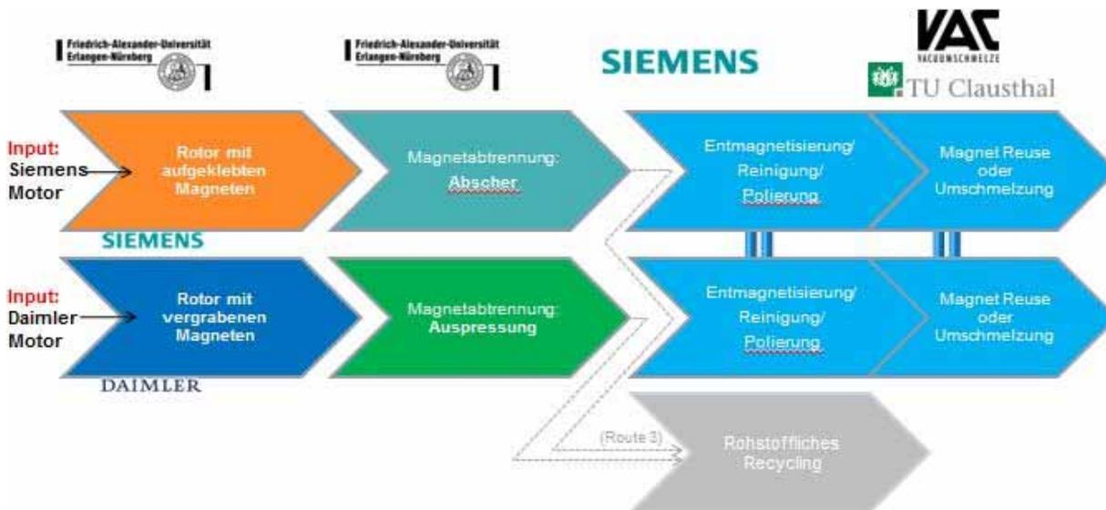
Motoren, die für MORE von Daimler zur Verfügung gestellt wurden, haben vergrabene Magnete, die aus dem Rotor gepresst werden müssen. Im Gegensatz dazu haben die Siemens-Motoren aufgeklebte Magnete auf dem äußeren Rand. Die in MORE entwickelten Prozesse trennen jeden einzelnen Magneten vom Rotor ab. Der Rotor wird zunächst von dem Motor bzw. Stator per Hand separiert.
