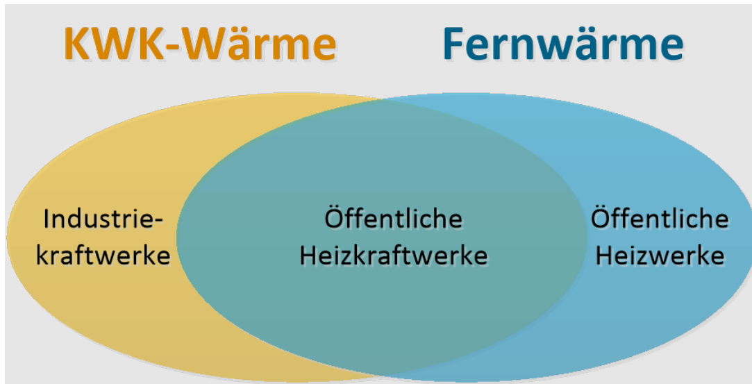
Abbildung 3-7: Begriffserklärung KWK-Wärme und Fernwärme
