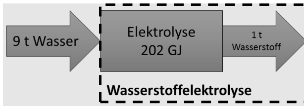
Abbildung 7-13: Prozessmodell Wasserstoffproduktion über Elektrolyse
