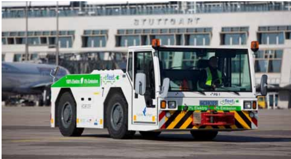
Abbildung 50: Elektrischer Flugzeugschlepper Schopf F110 electric im Einsatz am Flughafen Stuttgart (Quelle: Schopf)
