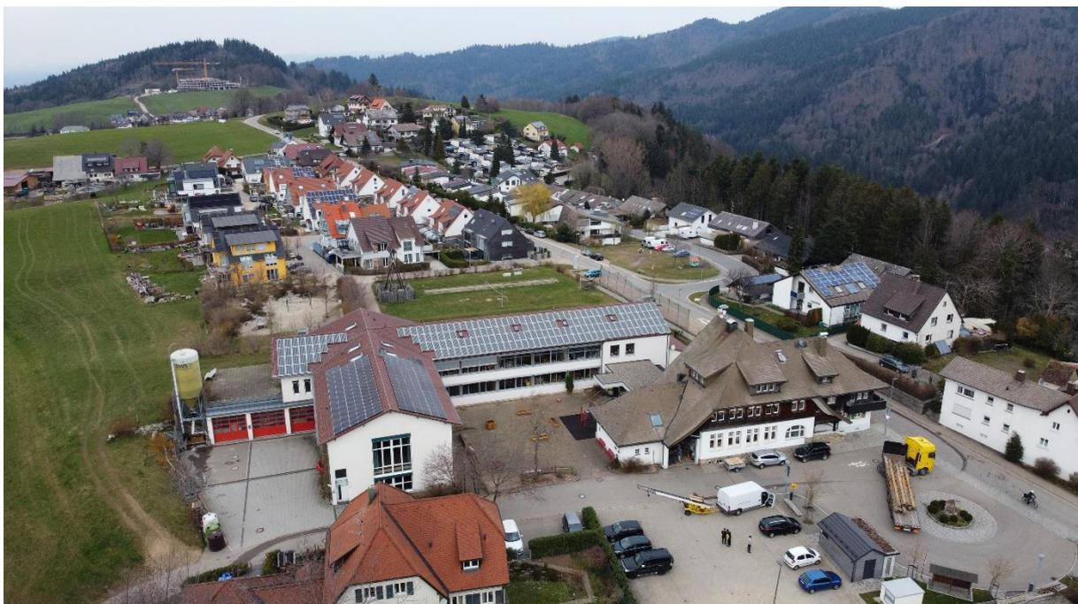
Abbildung 9: Luftaufnahme der Grundschule der Gemeinde Horben mit der nach Süden ausgerichteten, zu Projektbeginn bereits bestehenden PV-Anlage (auf dem langen Gebäude) und der nach Ost-West ausgerichteten neuen PV-Anlage (höheres Gebäude, auf dem Foto im Vordergrund)
